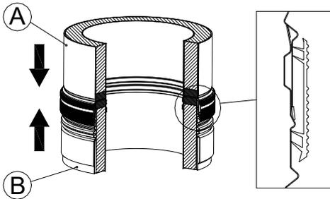
**ES** - Acoplar los dos extremos y posicionar junta tal y como se indica en la imagen.
