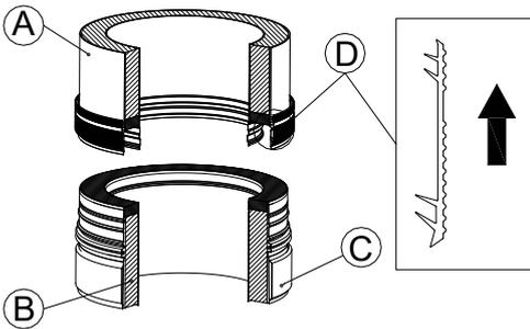
**ES** - Presentar abrazadera (C) en el extremo macho (B) y junta (D) en el extremo hembra (A).
