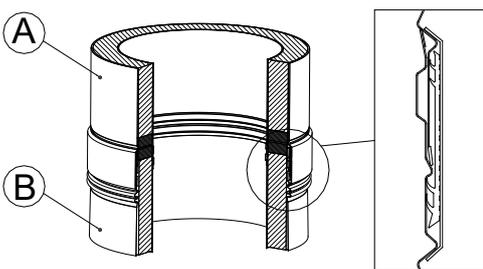
**ES** - Instalar la abrazadera de unión. Aplicar par de cierre según los rangos: \*
